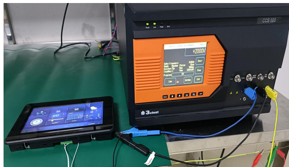
3.2 群脉冲测试图 EFT test
