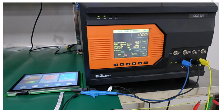
3.2 群脉冲测试图 EFT test
