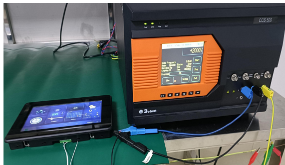
3.2 群脉冲测试图 EFT test
