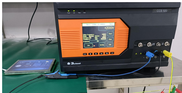
3.2 群脉冲测试图 EFT test
