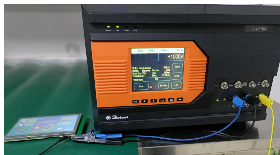
3.2 群脉冲测试图 EFT test
